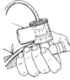
Şekil F-1. Tek Uzantılı Devrenin Hasta Ucunu Tıkamak
